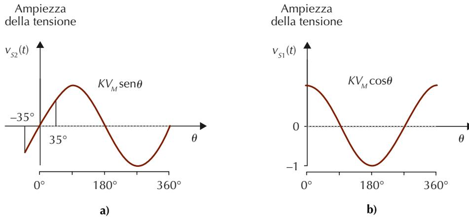
**Figura C2.11** Andamento delle ampiezze delle e tensioni  $v_{s1}(t)$  e  $v_{s2}(t)$  in funzione dell'angolo  $\theta$ .
